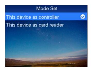
Step 3. Press 【↑】 key or 【↓】 key, select work mode, and press 【OK】 key as follows.
