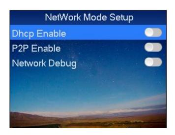
Step 4. Press 【↑】or 【↓】, select network mode to enable, and press 【OK】 to confirm.
